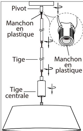
1. Vissez la tige du centre à la fixture. Installez la longueur de colonne requise en faisant passer le fil dans la colonne puis en vissant la colonne sur le luminaire. Installez le pivot sur la tige en vous assurant à ce que le manchon de plastique soit au niveau du pivot.
