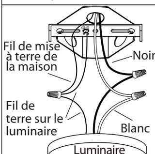
3. Branchez les fils de la mise a terre (cuivre nu ou vert) de votre montage au fil de la mise A terre (cuivre nu ou vert) ou vis de la mise a terre dans la boite electrique. Posez le fil noir (ou fil ayant un écriteau) de la fixture au fil noir dans la boite électrique et posez le fil blanc de la fixture au fil blanc dans la boite.
