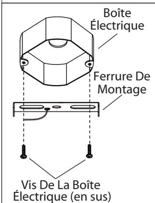
2. Ajustez le poteau à la longueur désirée et barrez en place avec cet écrou. Posez la ferrure d'installation à la boîte de sortie électrique à l'aide des vis de la boîte (en sus).
