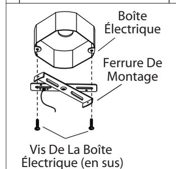
5. Posez la ferrure d'installation à la boîte de sortie électrique à l'aide des vis de la boîte (en sus).
