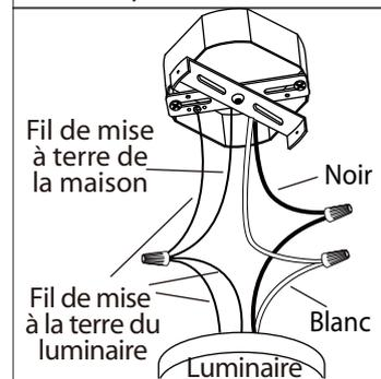
6. Branchez les fils de la mise a terre (cuivre nu ou vert) de votre montage au fil de la mise a terre (cuivre nu ou vert) ou vis de la mise a terre dans la boîte électrique. Posez le fil noir (ou fil ayant un écriteau) de la fixture au fil noir dans la boîte électrique et posez le fil blanc de la fixture au fil blanc dans la boîte.
