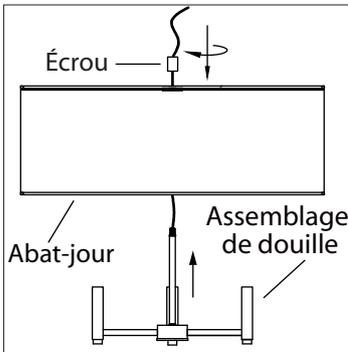
1. Installez l'assemblage de douille à l'abat-jour en resserrant l'écrou.
