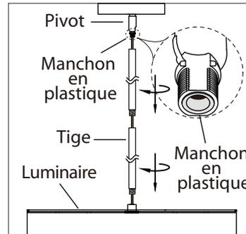
4. Installez la longueur de colonne requise en faisant passer le fil dans la colonne puis en vissant la colonne sur le luminaire. Installez le pivot sur la tige en vous assurant à ce que le manchon de plastique soit au niveau du pivot.
