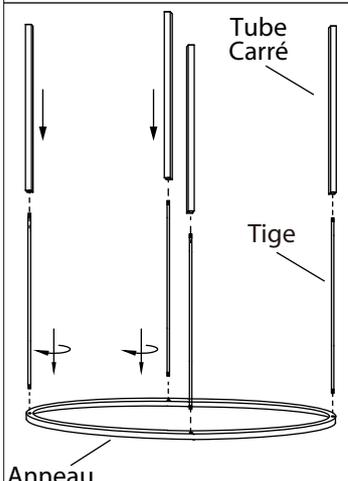
2. Retirez l'écrou des tiges. Vissez les 4 tiges sur l'anneau puis insérez les tubes carrés par-dessus les tiges.
